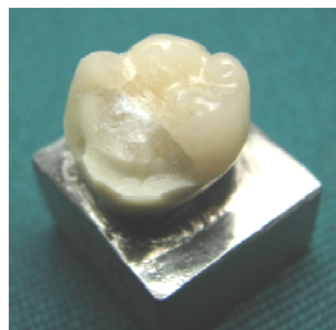
شکل ۷- پدیدگی لبه کور زیرکونیایی
